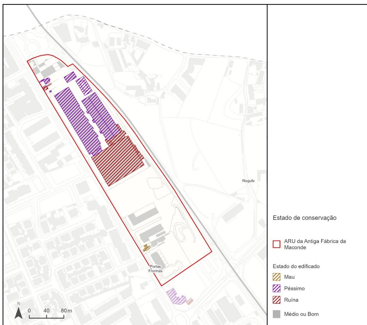
Figura 11 - Representação das edificações degradadas e em ruína na ARU da Antiga Fábrica da Maconde. Fonte: Trabalho de campo (2023).
