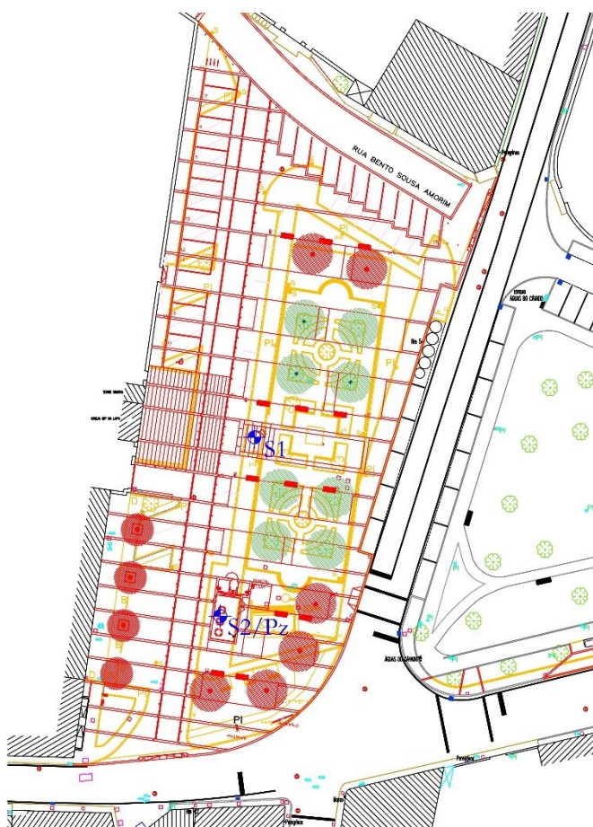
Figura 3 – Locais de execução dos furos de sondagem.
