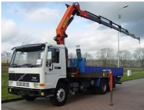
Figura 6.1-9 - Imagem relativa ao levantamento de equipamentos com camião grua
