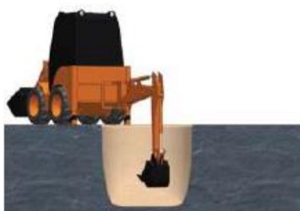
Figura 6.1-24 - Abertura da vala
