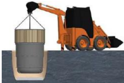
Figura 6.1-26 - Colocação do(s) poço(s) em PE.
