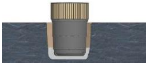
Figura 6.1-27 - Betonagem na envolvente e entre o(s) poço(s)
