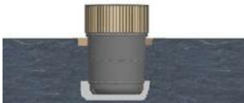
Figura 6.1-28 - Fecho da vala/aterro
