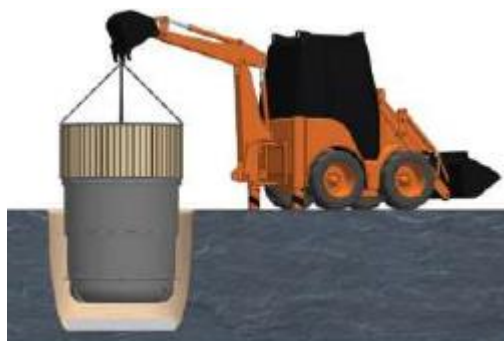
Figura 6.1-32 - Colocação do(s) poços em PE.
