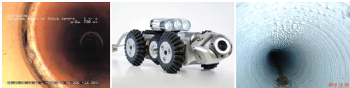
Figura 6.1-73 - Veículo de inspeção com câmara de vídeo e imagens de relatório
