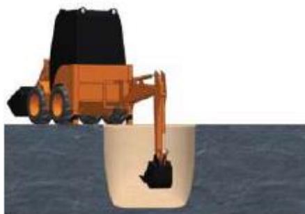
Figura 6.1-30 - Abertura da vala
