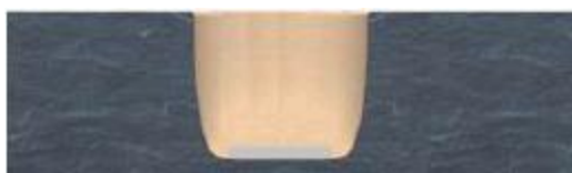
Figura 6.1-31 - Compactação e nivelamento do fundo de vala e execução de base em betão
