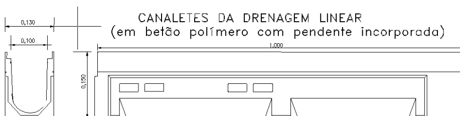
Figura 6.1-71 - Desenho de pormenor do canaleta de drenagem
