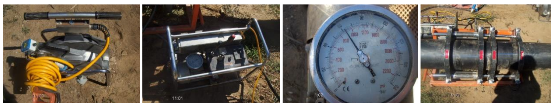
Figura 6.1-62 – Imagens referentes à máquina de solda topo a topo e sua execução
