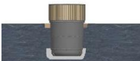
Figura 6.1-34 - Fecho da vala/aterro
