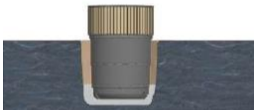
Figura 6.1-33 - Betonagem na envolvente e entre o(s) poço(s)
