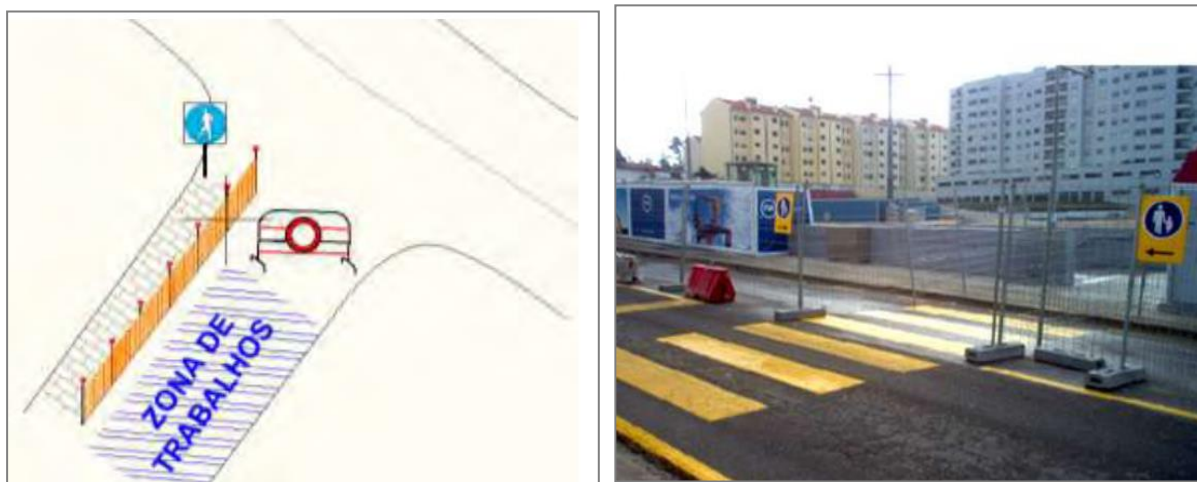
Figura 3.4: Esquema de sinalização temporária
