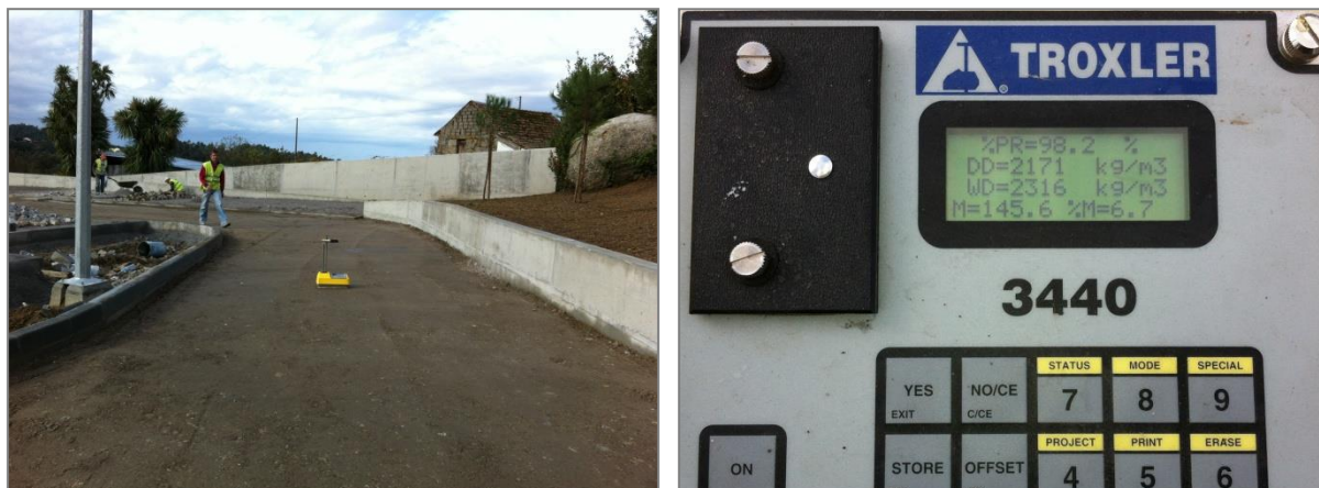
Figura 3.45: Ensaio de compactação do tout venant
