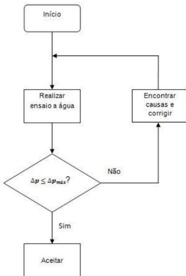
Figura 5.2 – Diagrama de fluxo para o ensaio de estanquidade com água
