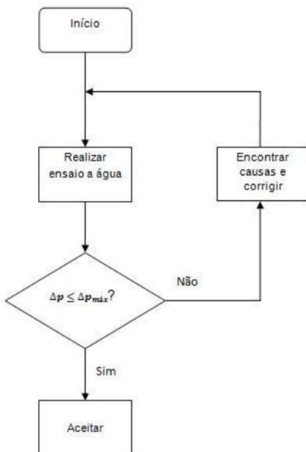
Figura 76: Diagrama de fluxo para o ensaio de estanquidade com água
