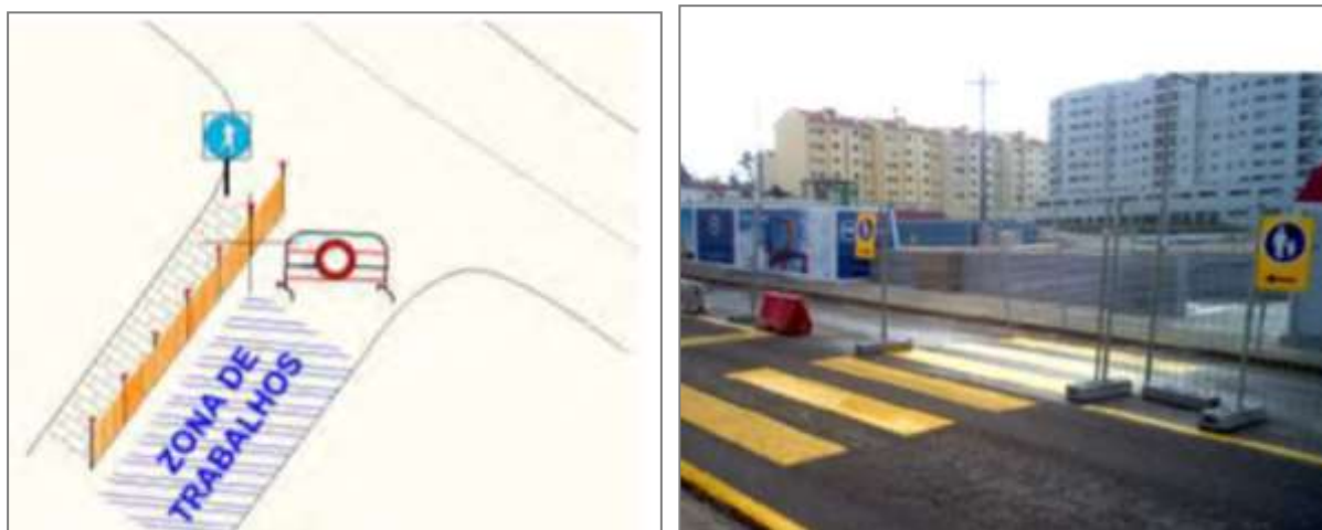
Figura 31: Esquema de sinalização temporária
