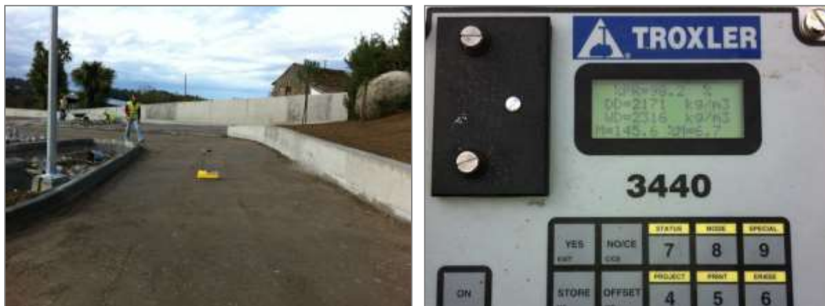
Figura 67: Ensaio de compactação do tout venant
