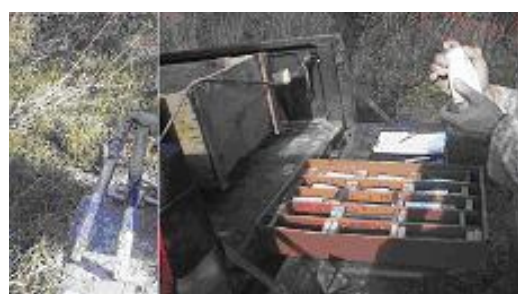
Figura 11 - Abertura do amostrador e acondicionamento da amostra
