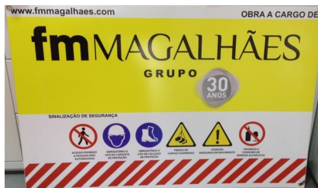
Exemplo de Sinalização à Entrada de Obra
