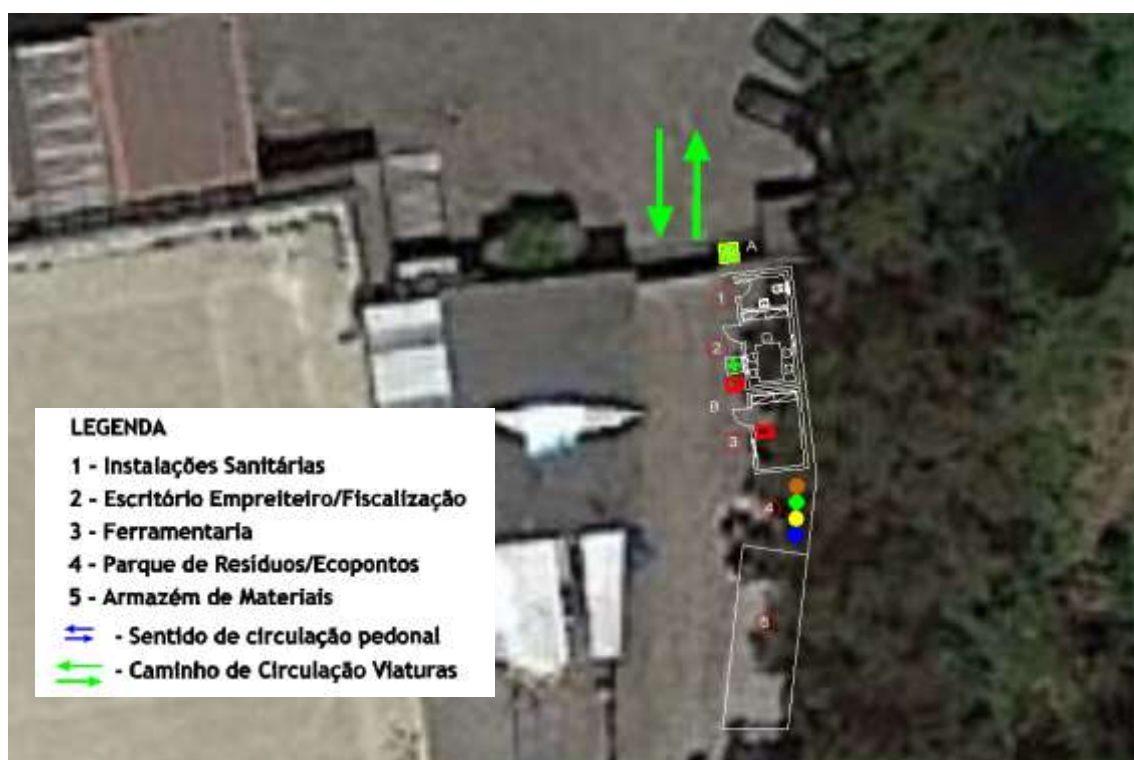
Figura 4.4 – Planta de estaleiro a implantar em obra
