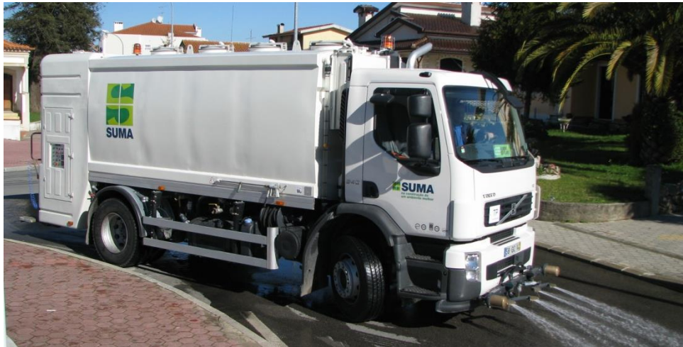
Figura 4-15 - Lavagem Mecânica de Arruamentos
