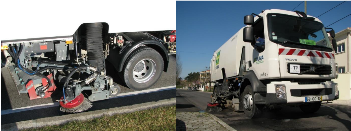
Figura 4-11 – Pormenor das Escova da Varredora Mecânica
