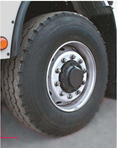
Eixo dianteiro com motores de cubo de roda hidrostáticos
