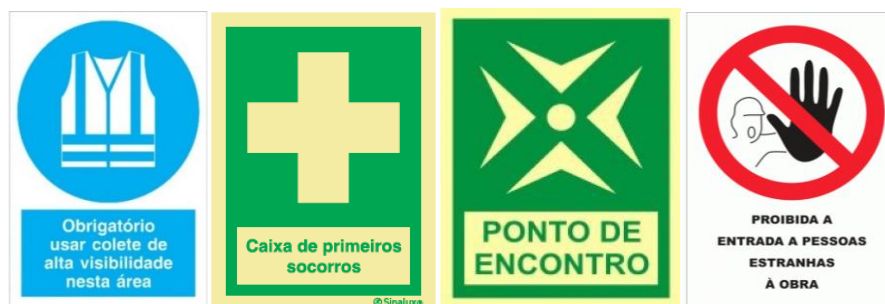
Figura 16 - Exemplo de sinalização no acesso à obra
