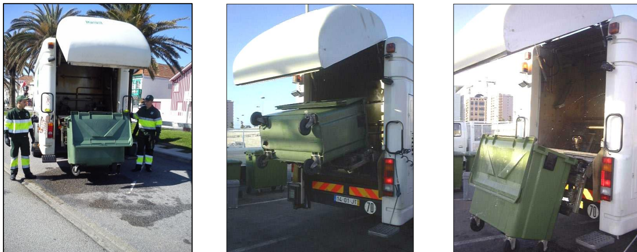
Figura 5-4 – Lavagem Mecânica do Contentor no Interior da Câmara da Viatura Lava-Contentores
