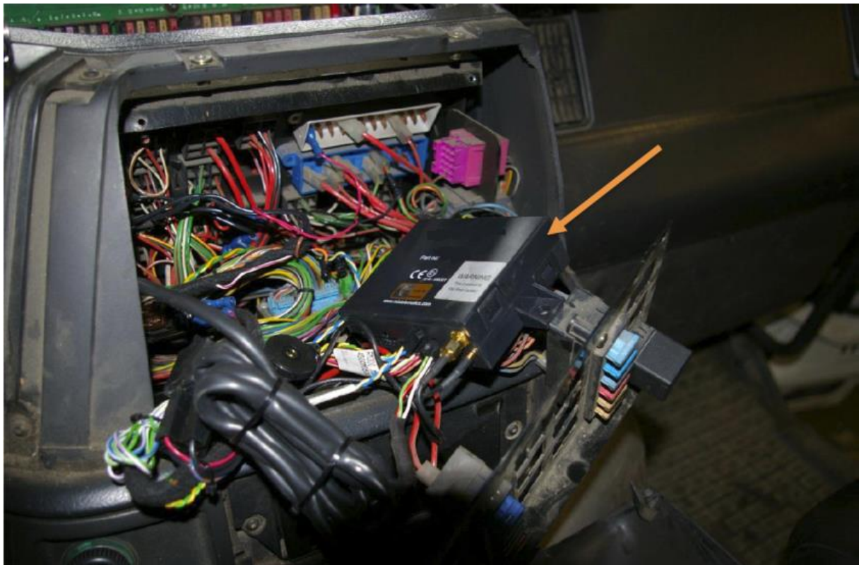
Figura 14-9 - Instalação de GPS numa viatura de recolha
