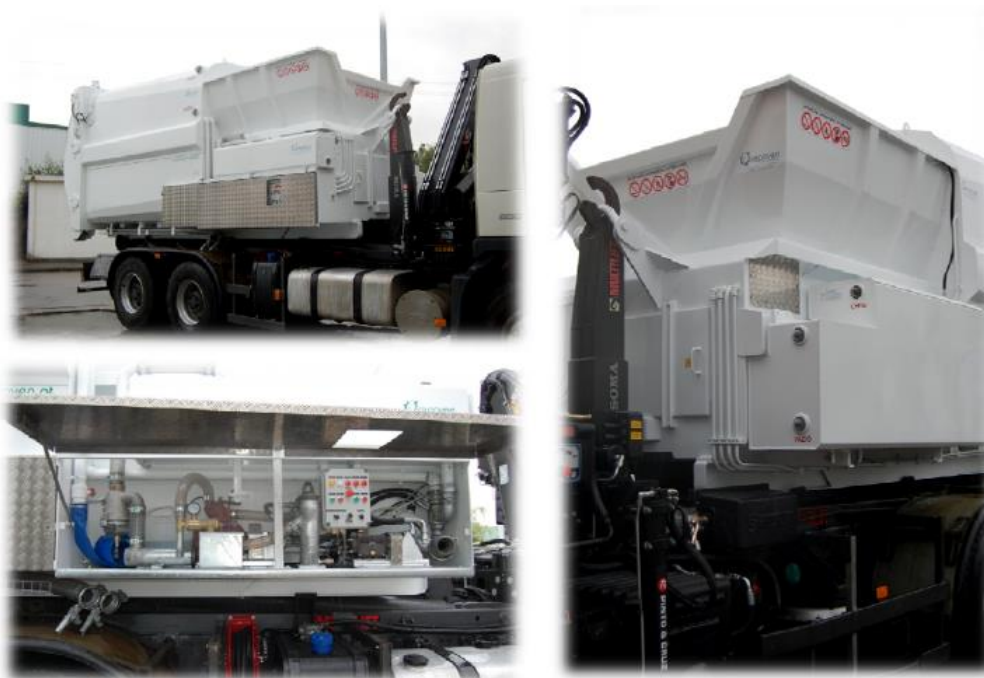
Figura 5-3 – Sistema de Lavagem que Equipa o Contentor Compactador de 20 m 3
