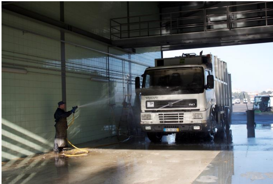
Figura 13-8 - Limpeza de viaturas e equipamentos em estaleiro
