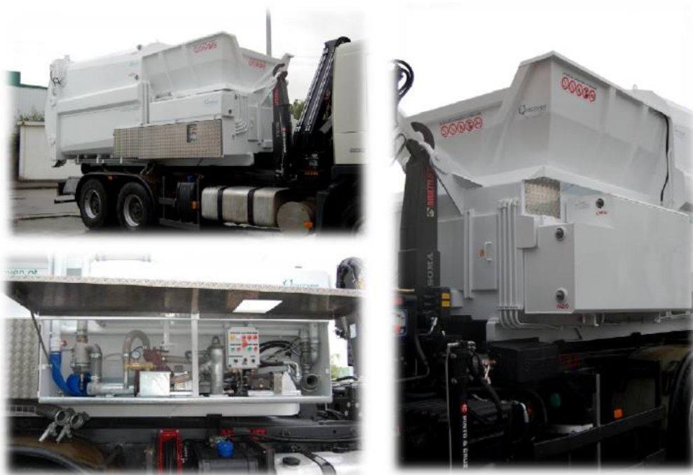
Figura 5-3 – Sistema de Lavagem que Equipa o Contentor Compactador de 20 m 3
