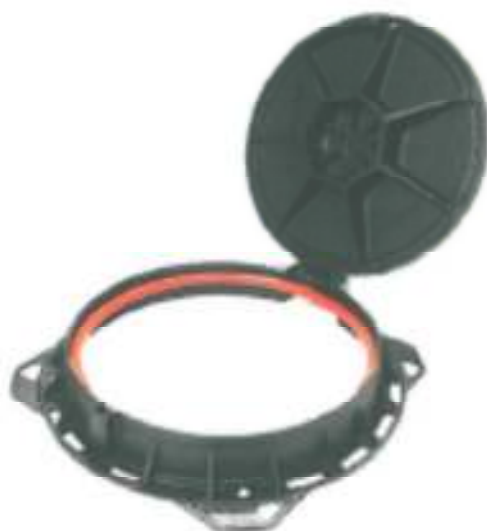
Tampa articulada, ângulo de abertura máximo 130 °, ângulo de bloqueio anti-retorno a 90°. Junta em PEPP (polietileno-polipropileno)
