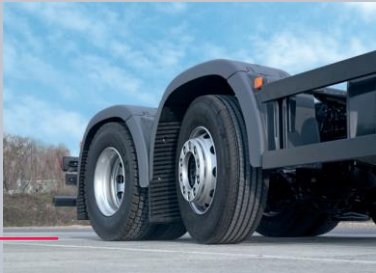
Eixo dianteiro direcciona1 e elevável no TGM
