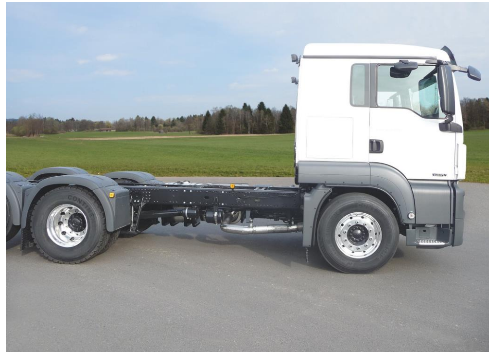
Lado direito de camião sem estrutura para montagem de carregador lateral
