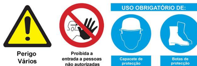
Ilustração 19 - Exemplo de sinalização em obra
