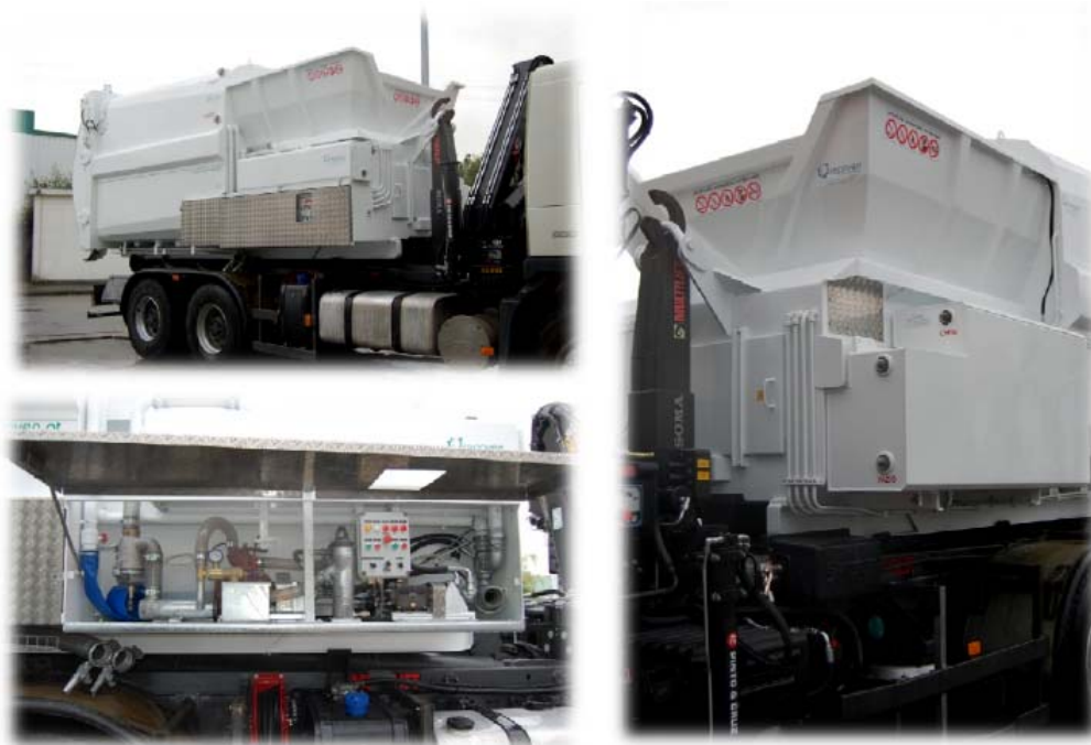
Fotografia 4-3 – Sistema de Lavagem que Equipa o Contentor Compactador de 20 m 3
