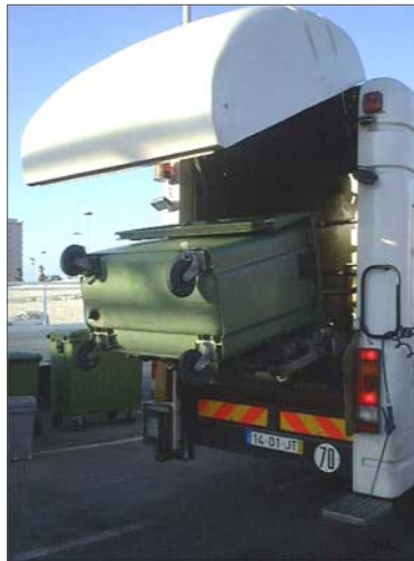
Fotografia 4-4 – Lavagem Mecânica do Contentor no Interior da Câmara da Viatura Lava-Contentores
