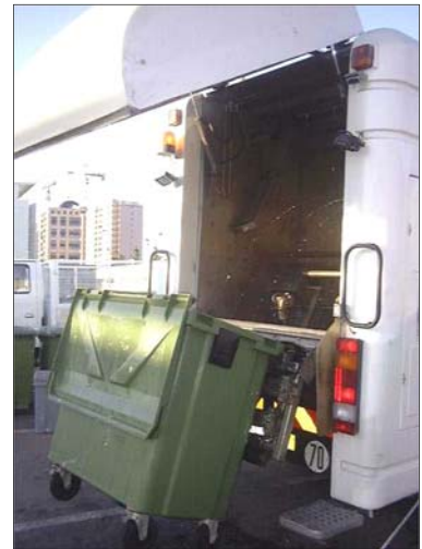
Fotografia 4-4 – Lavagem Mecânica do Contentor no Interior da Câmara da Viatura Lava-Contentores
