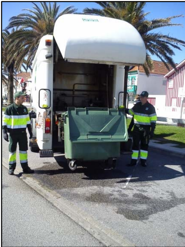
Fotografia 4-4 – Lavagem Mecânica do Contentor no Interior da Câmara da Viatura Lava-Contentores
