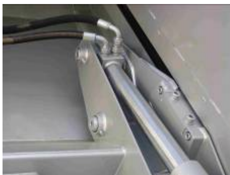
Veios do cilindro da placa giratória (revestimento em cromagem endurecida)
