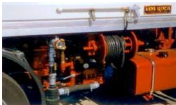
Enrolador manual com mangueira (15 m) e pistola de alta pressão
