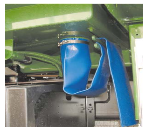
Vista exterior com a mangueira de drenagem
