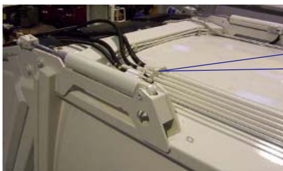
Tubagens hidráulicas com secções rígidas na caixa
