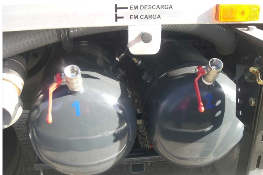
Depósito de detergente e/ou Desodorização
