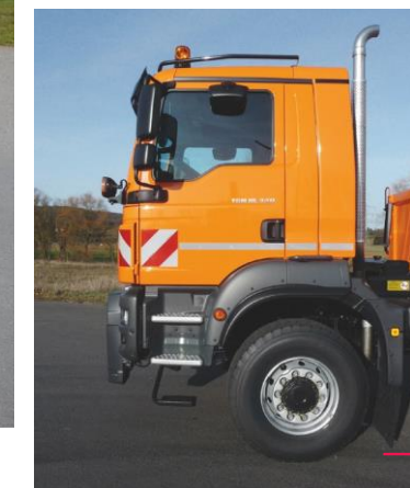
Extensão da cabine TGM
