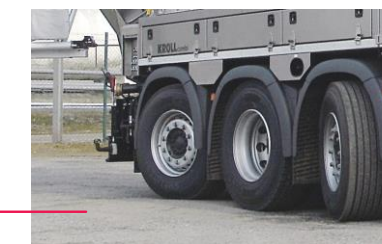
Veículo com eixo triplo com eixo dianteiro direccional e eixo de arrasto direccional.
